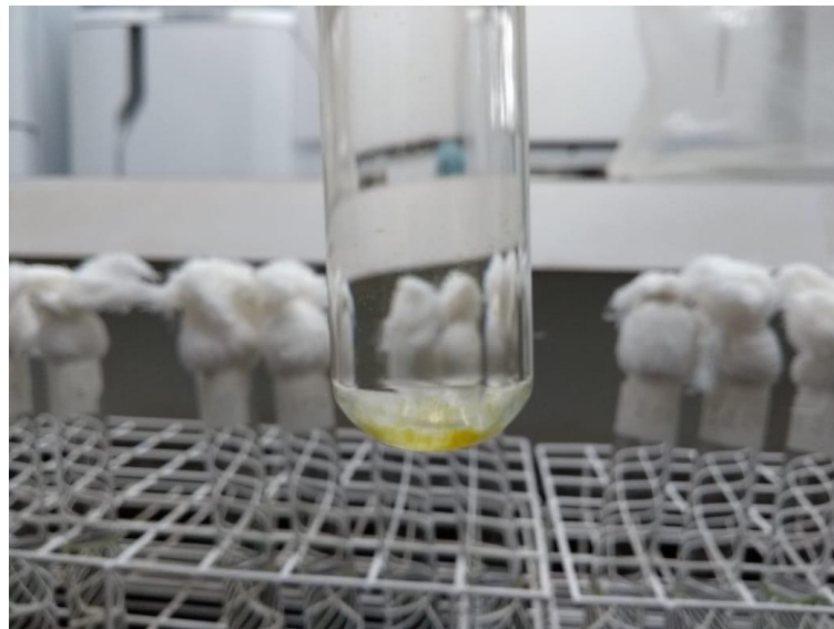
Figura 3: Meio de cultura para testes de ferro com material precipitado no fundo.
