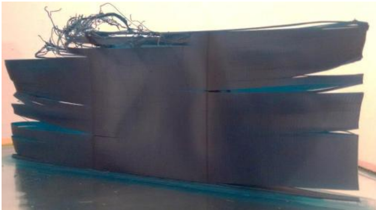
Figura 15 – Tentativa da impressão da asa utilizando ABS.
