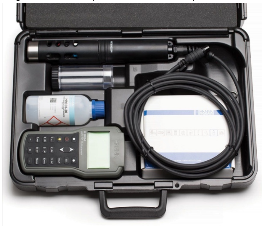
Figura 17 - Sonda multiparâmetro HANNA HI98194 para leituras de campo.
