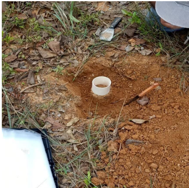
Figura 2 - Coleta de amostra indeformada de solo para análise de condutividade hidráulica saturada ( K_{sat} ).
