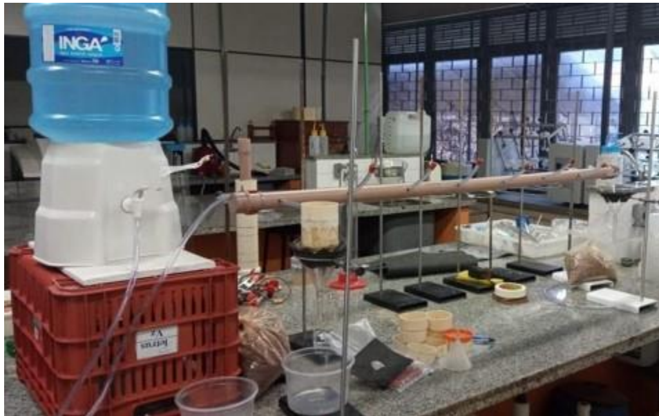
Figura 4 - Permeâmetro de carga constante confeccionado para a pesquisa.
