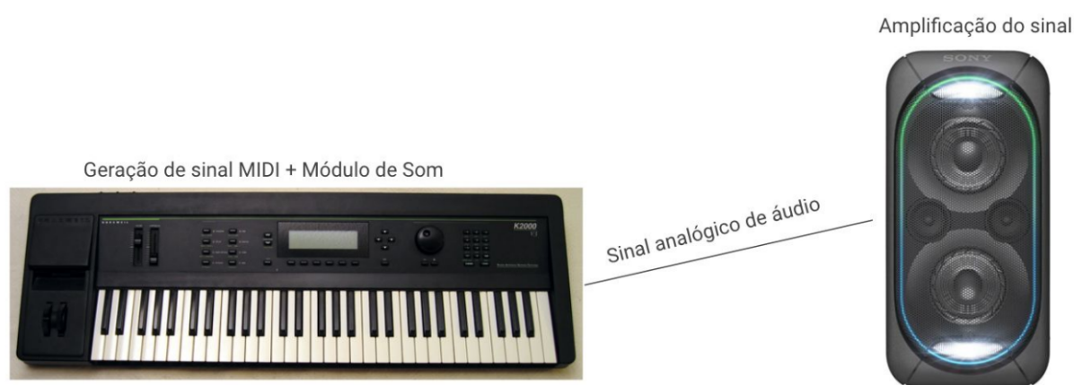
Figura 6 – Utilização de comunicação em MIDI internamente em um teclado, que envia o sinal analógico de áudio para um amplificador.
