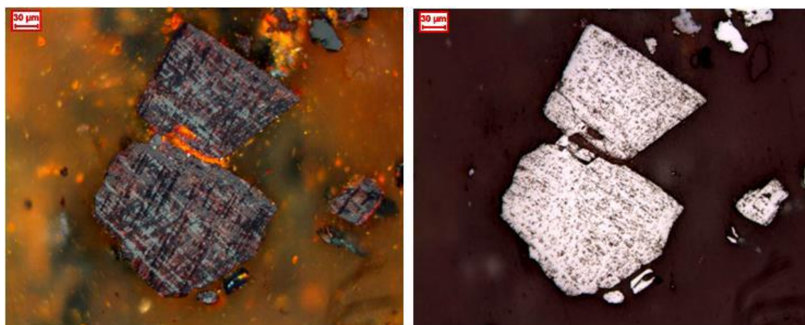
Figura 3.5 Fotomicrografias – microscópio de luz refletida - nicóis cruzados (esquerda) e paralelos (direita). Partículas contendo cristais de hematita martítica. (CPT – Centro de Pesquisas Tecnológicas VALE, 2013).
