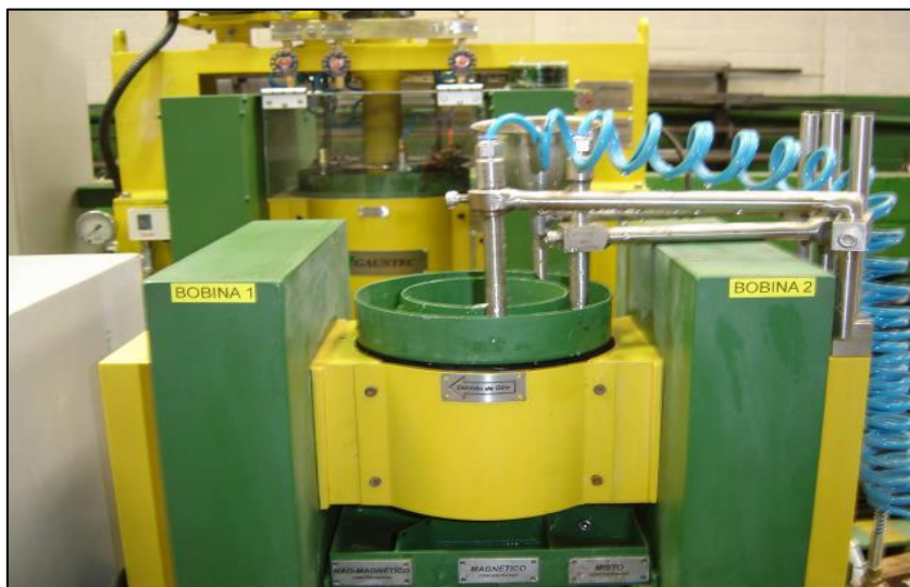
Figura 4.4 Concentrador eletromagnético Micromag. (VALE, 2014).
