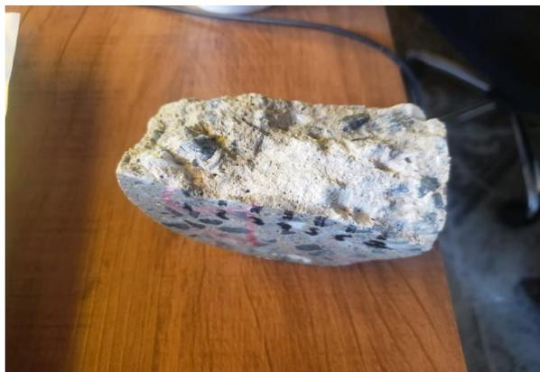
Figura 4. 14- Amostra após a aspersão de nitrato de prata com medidas de penetração.
