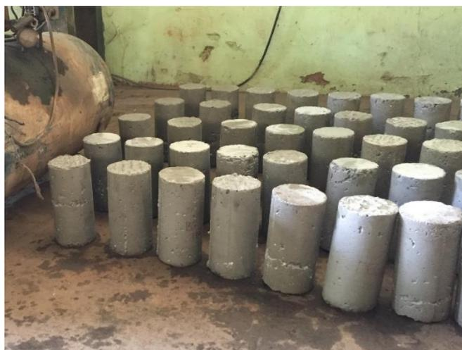
Figura 4. 5- Corpos de prova após imersão em solução aquosa de hidróxido de cálcio  $\text{Ca(OH)}_2$ .
