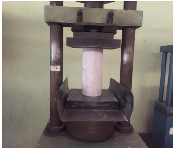
Figura 4. 7- Corpo de prova posicionado na prensa hidráulica para o ensaio de resistência à compressão axial.
