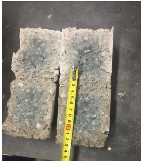
Figura 4. 6- Medição das alturas de capilaridade nos corpos de prova fraturados após ensaio de capilaridade.
