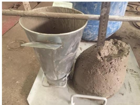
Figura 4. 3- Ensaio de consistência por abatimento do tronco de cone (slump test).
