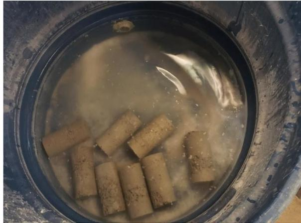
Figura 4. 9- Corpos de prova em solução de HCl 0,1 M.
