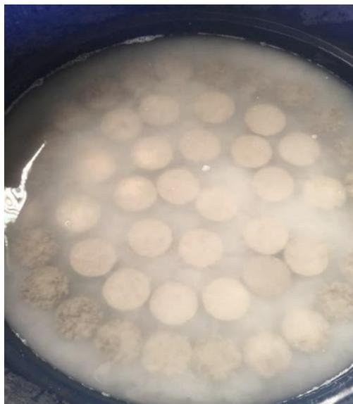
Figura 4. 4- Corpos de prova imersos em solução aquosa de hidróxido de cálcio  $\text{Ca}(\text{OH})_2$ .
