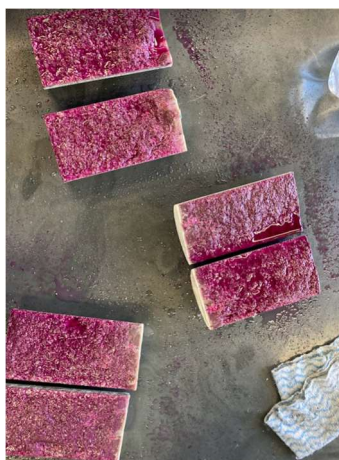
Figura 5.15 – CPs de referência rompidos à compressão diametral com 59 dias de carbonatação e aspergidos com fenolftaleína.
