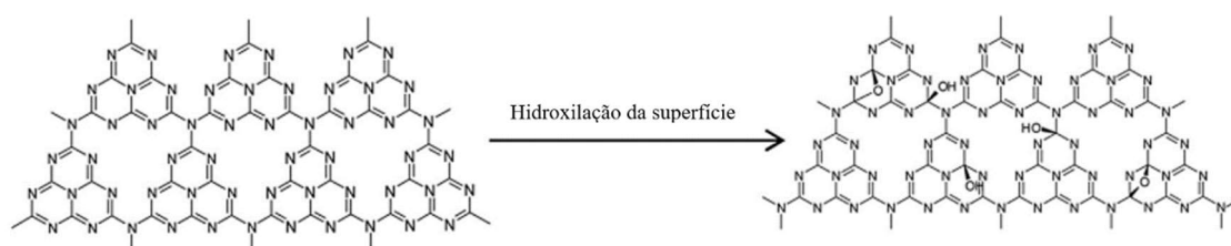
Figura 3.11 – Exemplo esquemático da modificação da superfície por grupos OHs. Adaptado de (ZHENG, ZHANG, et al. , 2016).
