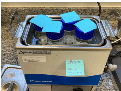
Figura 4.1 – Ultrassom de amostras de g-C_3N_4 com e sem H_2O_2 durante 10 minutos.
