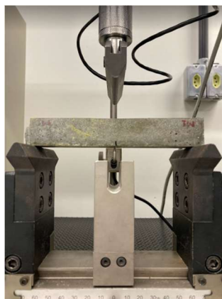
Figura 4.10 – Ensaio de Flexão por três pontos.
