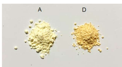
Figura 4.3 – Comparação da tonalidade entre as amostras A e D após secagem.
