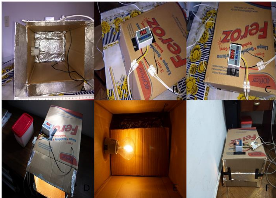
Figura 7 – Montagem da estufa: (A) Revestimento com papel alumínio e posicionamento do soquete para colocação da lâmpada; (B) e (C) Instalação e posicionamento do controlador de temperatura; (D) Estufa montada e preparada para receber o recipiente contendo Sitophilus sp.; (E) Vista interior da estufa mostrando o defletor de temperatura de papelão. O recipiente com Sitophilus sp. Foi colocado após o defletor para evitar incidência direta de calor e luz na preparação; (F) Visão geral do experimento, mostrando a estufa já com o recipiente no seu interior e o recipiente ao lado da estufa, ambos já contendo Sitophilus sp.
