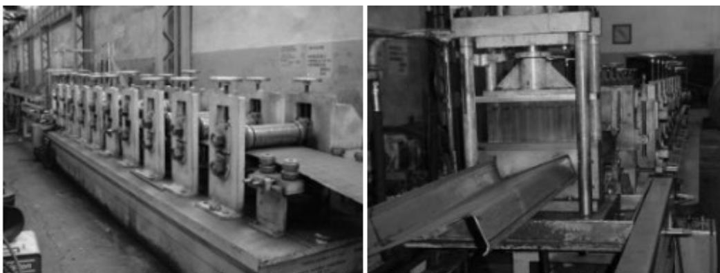
Figura 8 – Perfil Formado a Frio pelo processo de Conformação contínua
