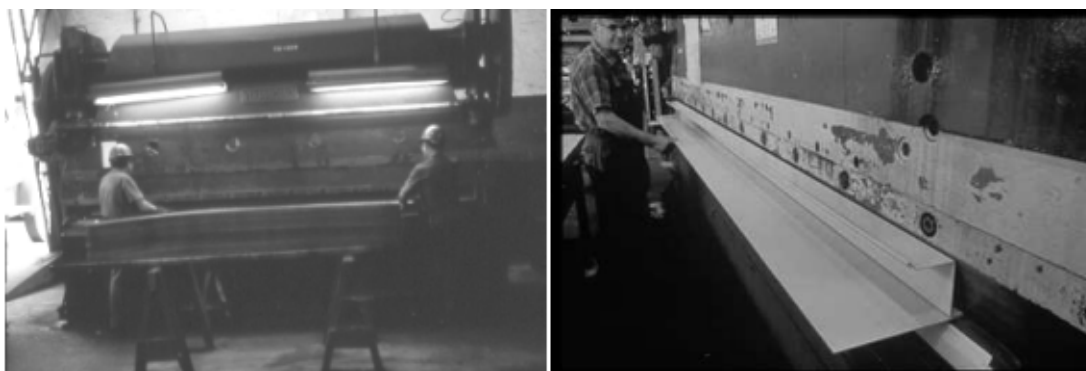
Figura 9 – Perfil Formado a Frio pelo processo de Dobramento
