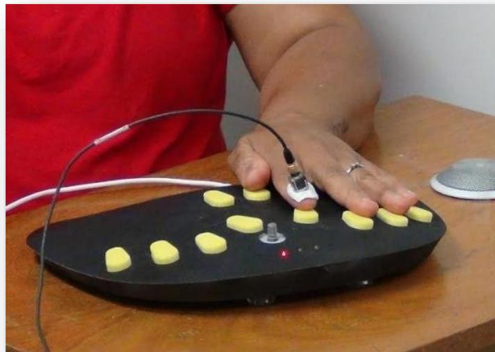
Figura 59 - Posicionamento do acelerômetro triaxial para a medição das vibrações.
