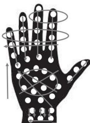
Figura 24 - *Lorm Glove*, com representação do alfabeto Lorm em cinza e dos sensores em branco.
