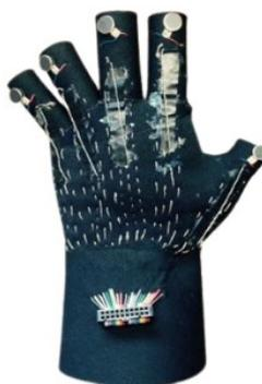
Figura 31 - Protótipo 4 com materiais resistentes a vincos, a altas temperaturas, com impermeabilidade e proteção contra produtos químicos.
