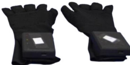
Figura 32 - Protótipo Luvas 4 revestido e com circuito interno próprio acondicionado em uma caixa.
