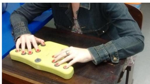
Figura 39 – Postura anti-ergonômica durante o uso do teclado Asas.
