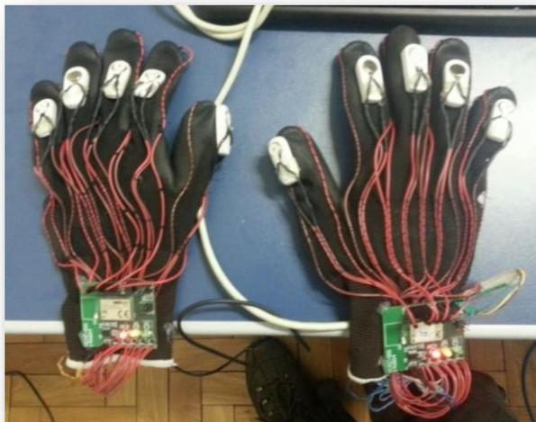
Figura 29 – Protótipo Luvas 3 feito com poliamida, elástico e poliuretano.
