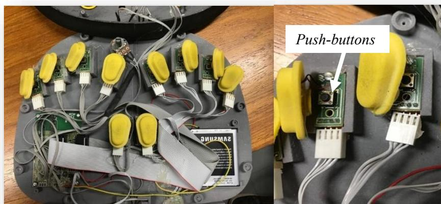
Figura 41 - Deslocamento dos botões do protótipo Ziba.
