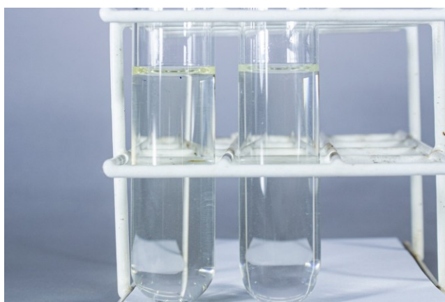
Figura 4.8. Solução coloidal de CTAC (à esquerda) e emulsão ácida W/W (à direita).
