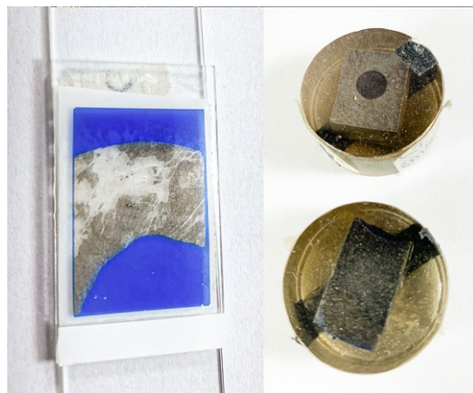
Figura 4.4. Lâmina delgada para microscopia óptica, AFM e nanoindentação (esq.). Secções polidas para MEV e EDS (dir.).
