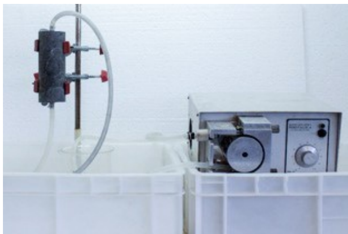
Figura 4.2. Acidificação das amostras do Formação Sete Lagoas para posterior caracterização microscópica e nanoindentação
