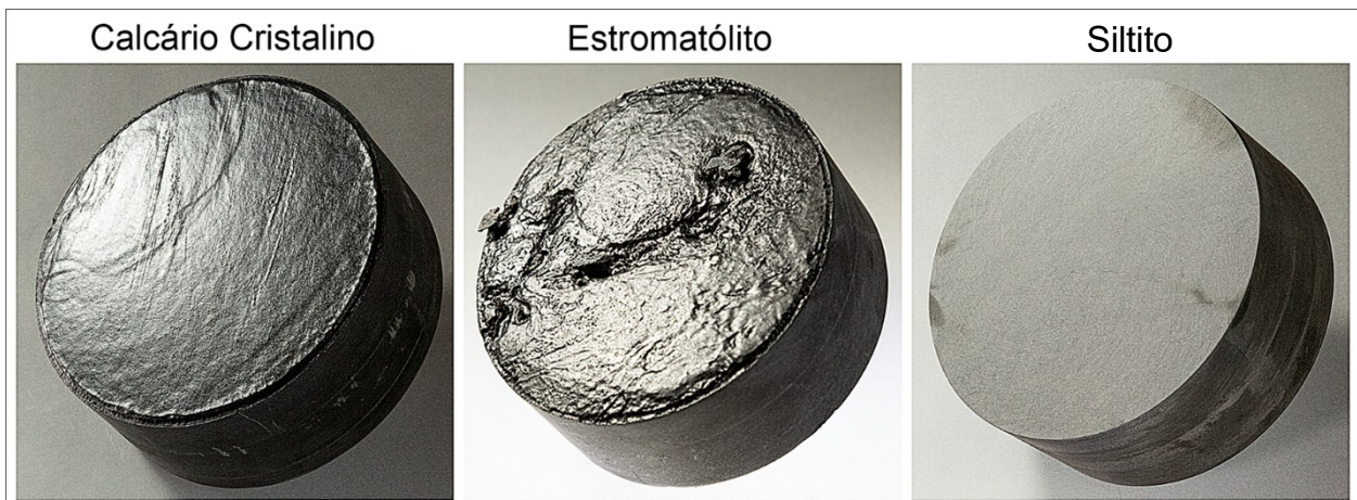
Figura 4.6. Corpos de prova com superfícies acidificadas para os testes de incorporação de propante. O ataque ácido, que cria asperezas nas superfícies acidificadas, foi claramente mais acentuado no estromatólito do que nos outros dois tipos de calcário.
