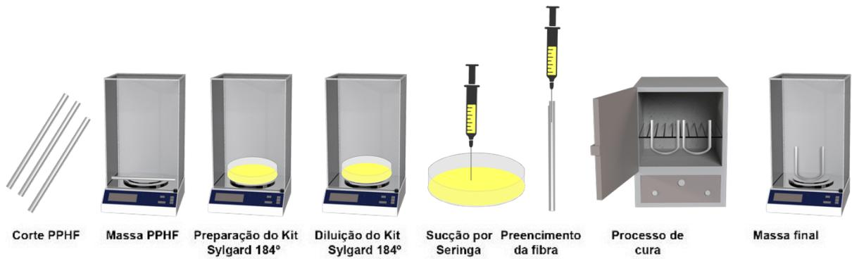
**FIGURA 9.** Processo de produção da fibra de extração PP-PDMS
