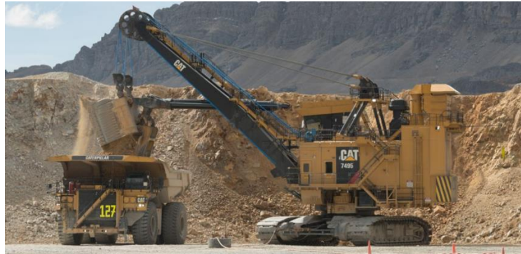
Figura 3: Escavadeira a cabo – Caterpillar 7495.
