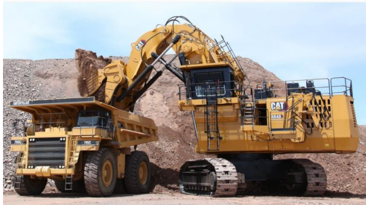
Figura 2: Escavadeira hidráulica Front Shovel – Caterpillar 6040.
