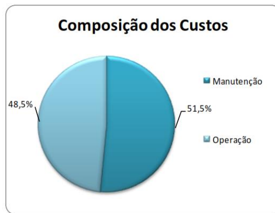
Figura 9: Composição dos custos operacionais de transporte por caminhões na Austrália e nos E.U.A.
