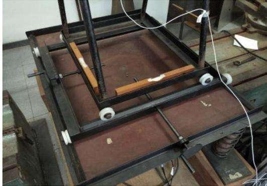
A cadeira tem seu assento e encosto de madeira e pés metálicos e apesar de se configurar como desconfortável para longos experimentos, é dessa forma para que o amortecimento das vibrações seja mínimo, e possa ser inferido que a vibração gerada pela plataforma seja bem próxima aos valores que o corpo do voluntário irá receber.
