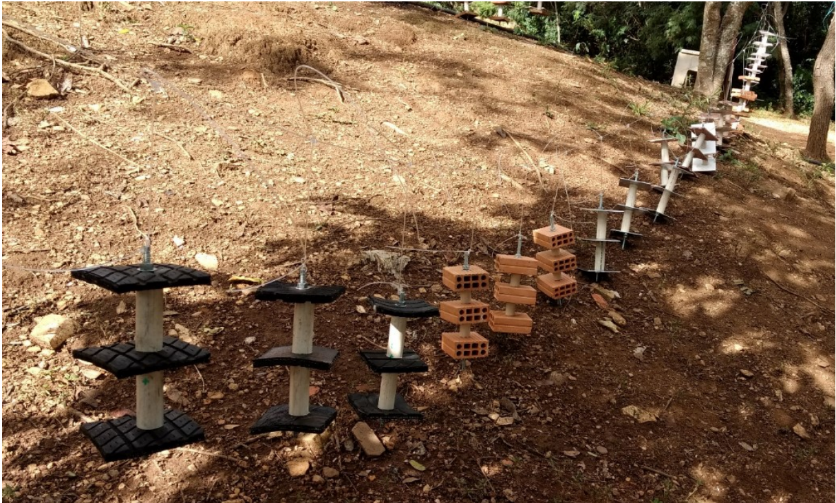
Figura 14. Montagem real de uma das 3 fileiras de amostras com diferentes materiais, distribuídos em conjuntos de três placas (triades), momentos antes da colocação na água. Foto: Jennifer TM Andrade.
