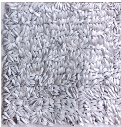
Figura 1 – Placa cerâmica incrustada artificialmente com MD.
