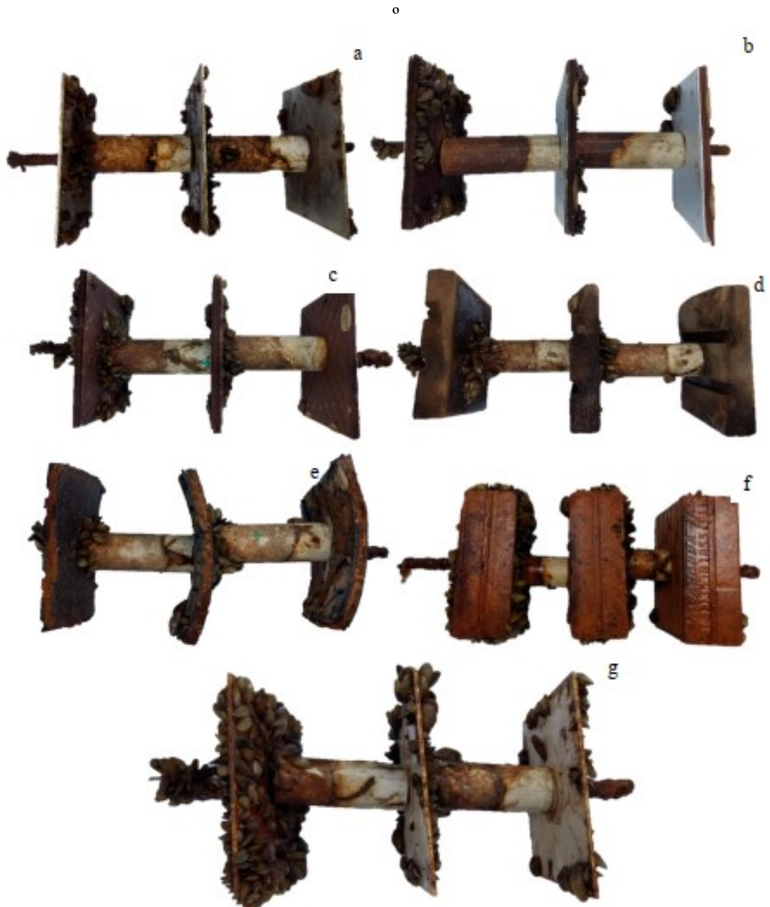
Figura 15. Tríades dos materiais incrustados com mexilhão dourado, deslocados em 90° para realização das fotografias. a-Alumínio; b-Cerâmica com parte lisa para cima; c-Cerâmica com parte lisa para baixo; d-Madeira; e- Pneu; f-Tijolo e g-PVC.
