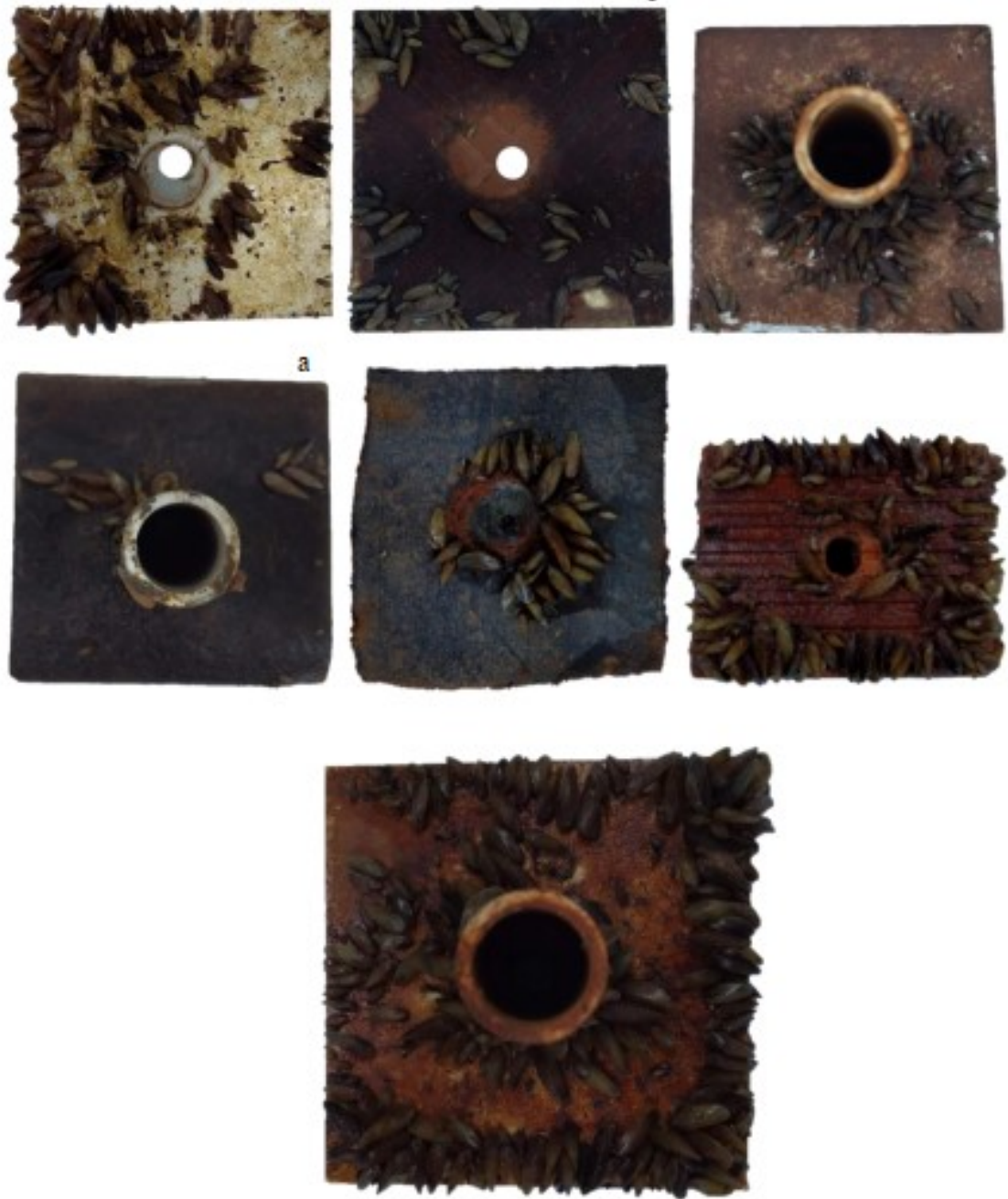
Figura 16. Placas dos materiais: a-Alumínio; b-Cerâmica com parte lisa para cima; c-Cerâmica com parte lisa para baixo; d-Madeira; e- Pneu; f-Tijolo e g-PVC.
