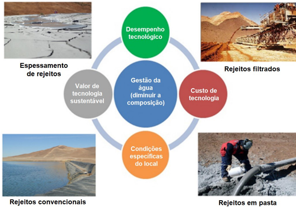
Figura 3.5 - Tecnologias de desaguamento de rejeitos
