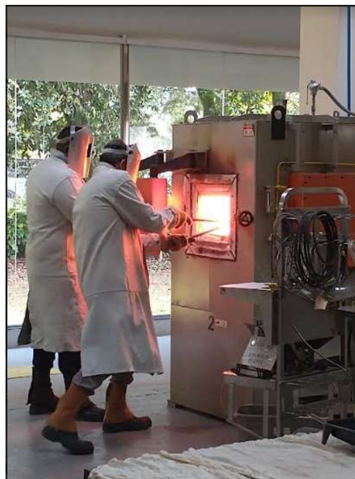
Figura 24: Momento em que uma das amostras é retirada do forno elétrico durante o tratamento térmico.
