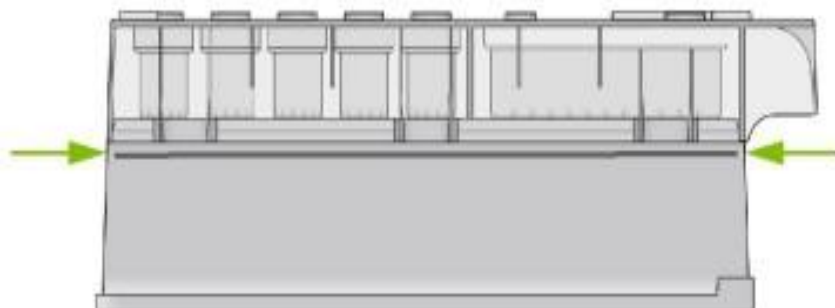
Figura 2: Linha de marcação que determina o máximo de água que se deve mergulhar o cartucho. Fonte: MiSeq FGX Instrument Reference Guide - Verogen® .
