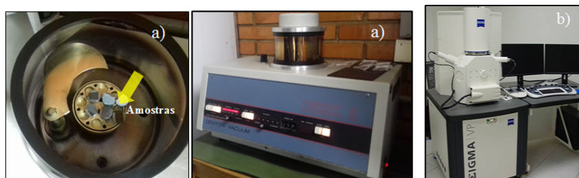
Figura 18 – Análise no MEV: (a) Metalização de ouro da amostra; (b) Equipamento SIGMA VP.
