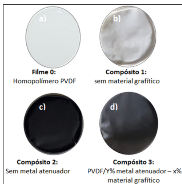
Figura 13 – Filmes Poliméricos sintetizados a partir da rota de sintetização esquematizada na Figura 12 a) Filme 0: homopolímero PVDF; b) Compósito 1: PVDF com metal atenuador; c) compósito 2: PVDF com material gráfitico; d) compósito 3: PVDF/Y% metal atenuador - x% material gráfitico.
