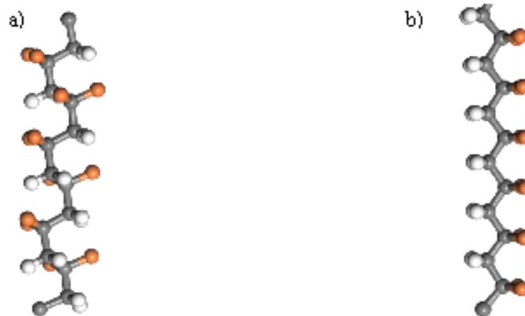
Figura 2 – Representação esquemática dos segmentos de cadeia do PVDF na conformação a) trans e gauche ( TG^+ TG^- ) e b) trans (TTT) (adaptado de Jalarvo et al., 2015 (JALARVO et al., 2015)).
