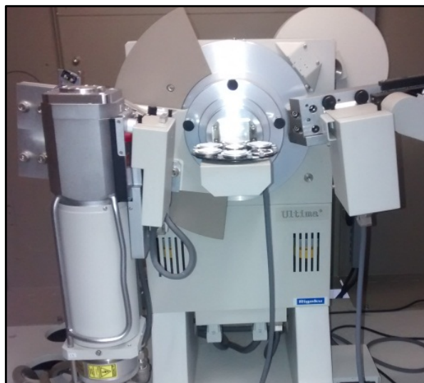
Figura 22 – Equipamento de difração de raios X Rigaku, modelo e sistema D\MAX ULTIMA automático.
