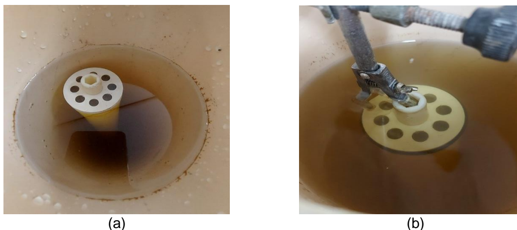
Figura 5.3.1 - Presença de sólidos na solução de limpeza da membrana (a); coloração escura observada no NaClO durante o tratamento oxidativo do módulo (b).
