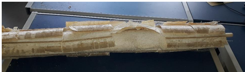
Figura 4.2.1 - Módulo de OI descartado após abertura
