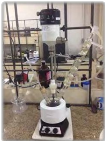
Figura 1 – Montagem utilizada para a reação de liquefação.
