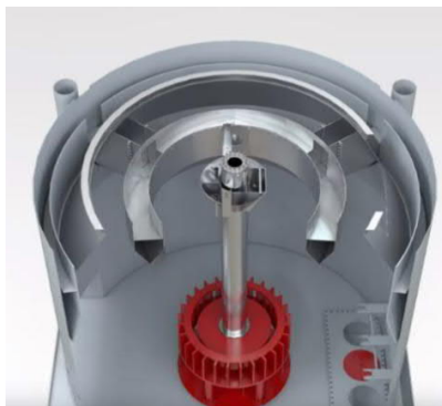
Figura 3.27 – Tanque com a calha central (Manual Metso Outotec).
