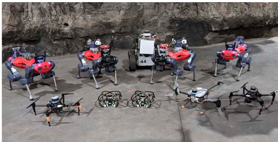
Figura 2 – Plataformas robóticas utilizadas pela equipe CERBERUS na final da DARPA Subterranean Challenge . Fonte: [Evan Ackerman, 2021].
