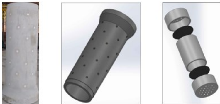
Figura 6.1 Tubo permeável com filtros acoplados e detalhe dos filtros Fonte: arquivo próprio, 2019
