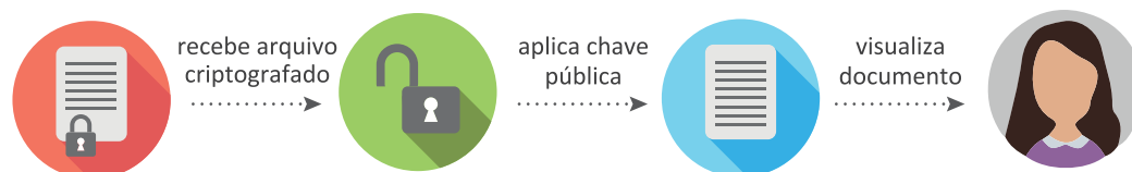
Figura 14 – Fluxograma do ciclo de utilização dos documentos clínicos em base digital com assinatura certificada
