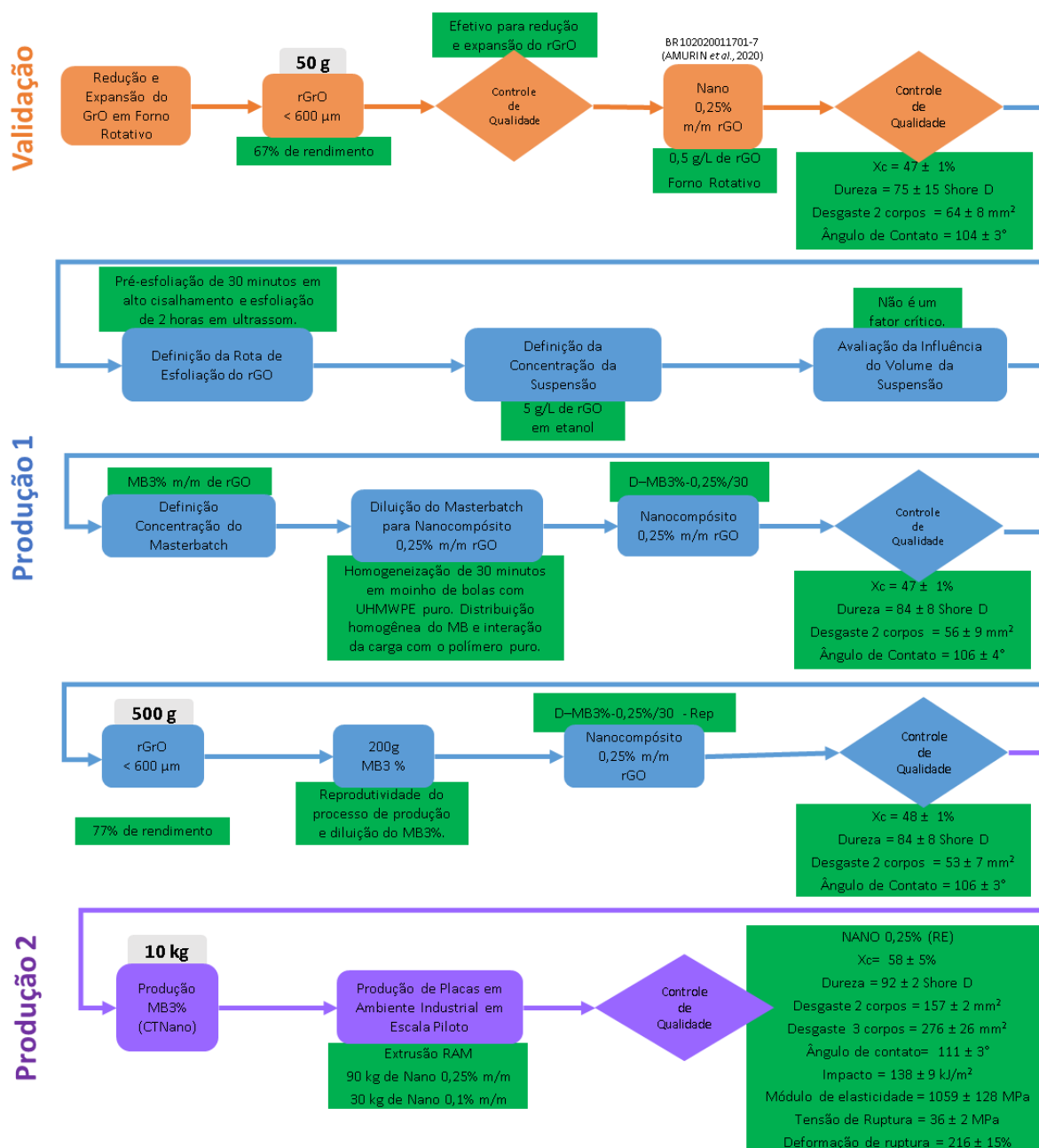
Figura 61 - Fluxograma de todas as etapas e os principais resultados obtidos no trabalho de escalonamento.
