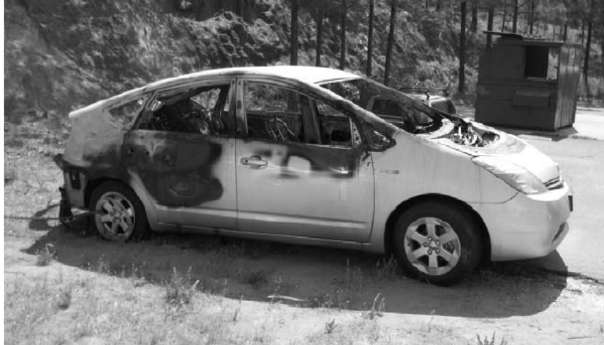
Figura 1.8: Automóvel Prius PHEV após incêndio no pacote de baterias de Li-Ion. Fonte: [27].
