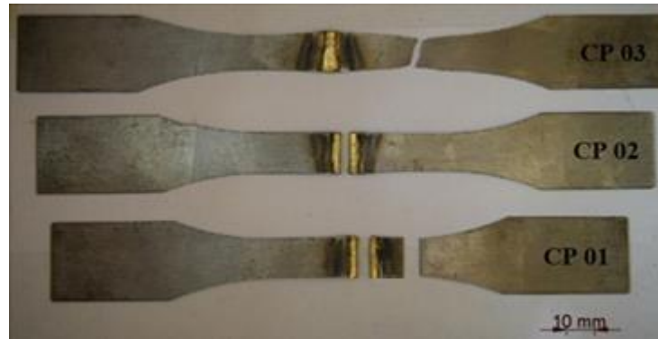
Figura 5.20 – Corpos de prova ensaiados (chapa sem revestimento; arame BT 531; sem abertura)
