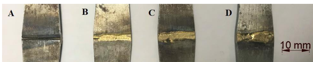
Figura 5.18 – Preenchimento do metal de adição nas juntas
