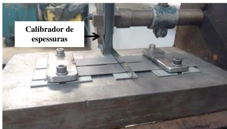
Figura 4.6 – Utilização do calibrador de espessuras para junta de 1,0 mm de abertura
