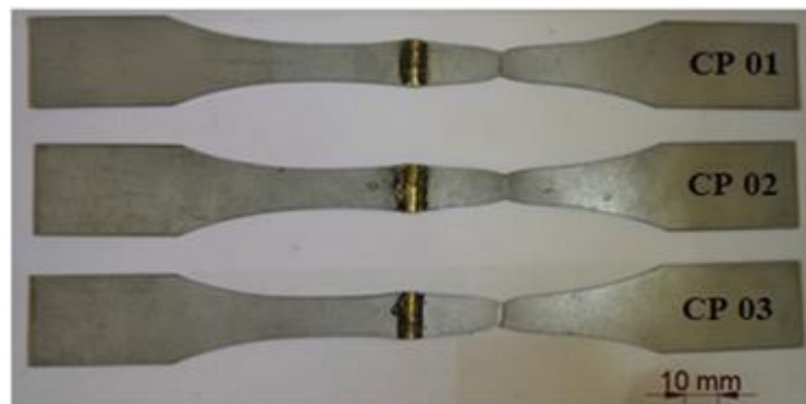
Figura 5.22 – Corpos de prova ensaiados (chapa galvanizada; arame BT 531; abertura de 0,5 mm)
