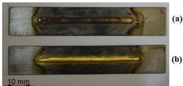
Figura 5.7 – Corpos de prova de chapa sem revestimento brasados
