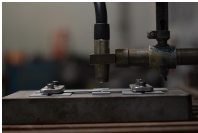
Figura 4.7 – Corpos de prova a serem unidos com abertura de 1,0 mm
