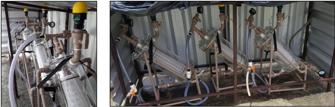
Figura 4.10: Instalação em campo das unidades de formação das membranas dinâmicas em série
