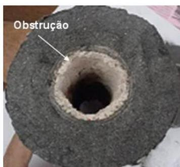
Figura 6 : Válvula submersa com destaque para obstrução parcial<sup>(11)</sup>
