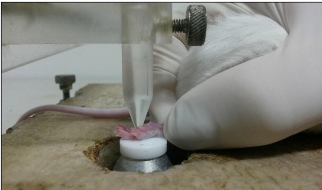
Figura 16 - Parte compressora do aparelho (Ugo Basile, Itália) utilizado para medir o limiar de resposta ao estímulo mecânico aplicado na pata de camundongos.
