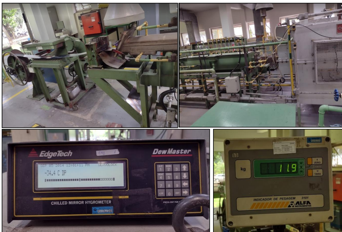
Figura 4.10 – Forno contínuo, medidor de ponto de orvalho e monitoramento contínuo da tração de processamento, durante o processamento das amostras
