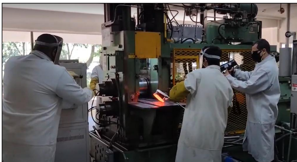
Figura 4.5 – Monitoramento da temperatura da amostra antes da laminação à quente após o enformamento entre passes
