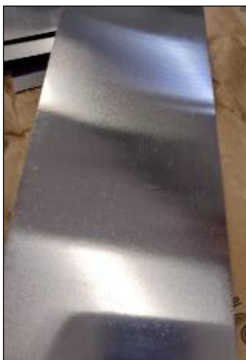
Figura 4.9 – Amostra após laminação a frio, espessura final e largura 100mm
