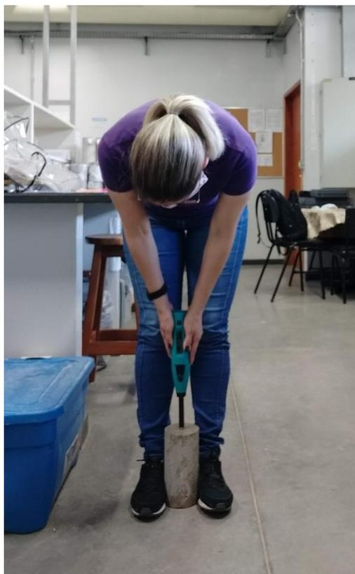
A NBR 7.584 (ABNT, 2012) determina que, para ensaios em peças concretadas, a quantidade de golpes deve ser de 16 golpes em uma área de impacto respeitando o distanciamento de 30 mm entre cada golpe. Além disso deve-se evitar aplicar golpes em locais menos de 50 mm da extremidade da peça
