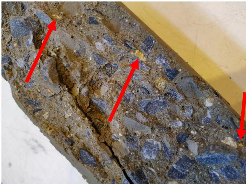
Tem-se, então, o primeiro resultado deste estudo experimental, a respeito de algumas propriedades reológicas, comparando-se o concreto CM com o concreto CR: a) trabalhabilidade: o concreto com substituição parcial por metacaulim teve a sua trabalhabilidade dificultada em relação ao CR; e b) integridade da massa de concreto: no teor de 20% de substituição do cimento por metacaulim não houve segregação, e ambos os concretos se apresentaram uniformes após desforma.
