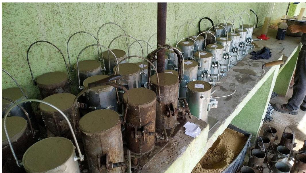
Após as 12 horas, 9 unidades do concreto CR e 9 unidades do concreto CM foram desformados para submissão aos primeiros ensaios e os demais ficaram armazenados em suas formas.
