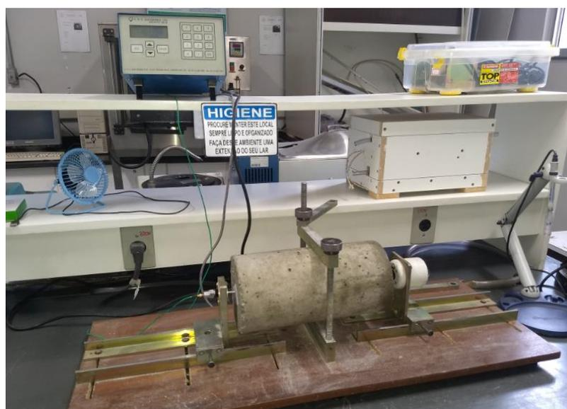
Os ensaios de frequência ressonante forçada, no modo longitudinal, foram executados baseado nas normas C 215 (ASTM, 2008) e BS 1881: Part 209 (BSI, 1990). Neste ensaio as amostras sofreram vibração por meio de uma unidade motriz eletromecânica até atingir a sua amplitude máxima, quando a frequência de vibração se iguala à frequência natural da amostra, sendo esse o valor da frequência ressonante ( $F_r$ ).
