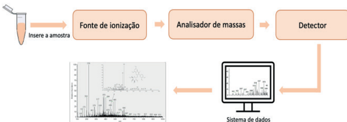
Figura 1. Esquema simplificado dos principais componentes de um espectrômetro de massas.
