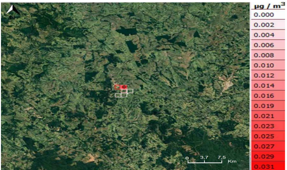
Figura 20. Dispersão de \text{NO}_x em junho de 2017 no SIMPACTS. Fonte: Adaptado de Google Earth.
