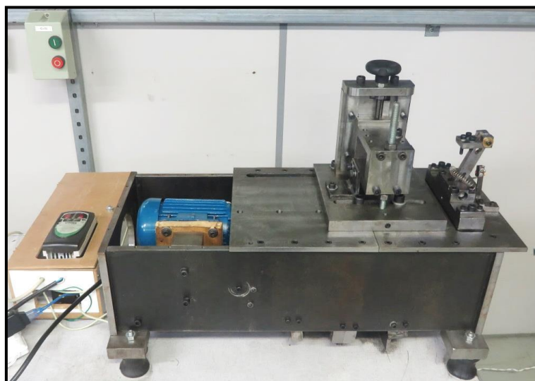
Figura 8: Máquina para ensaio de fadiga por flexão.
