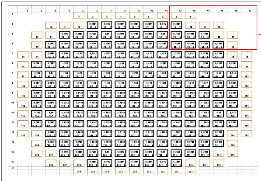
Fig.1 – Exemplo de núcleo padrão PWR.
