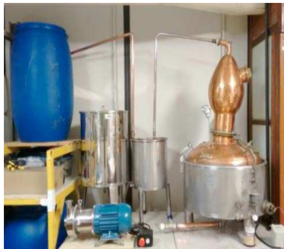
Figura 2 - Alambique de cobre acoplado a um condensador em aço inox, no processo de destilação.
