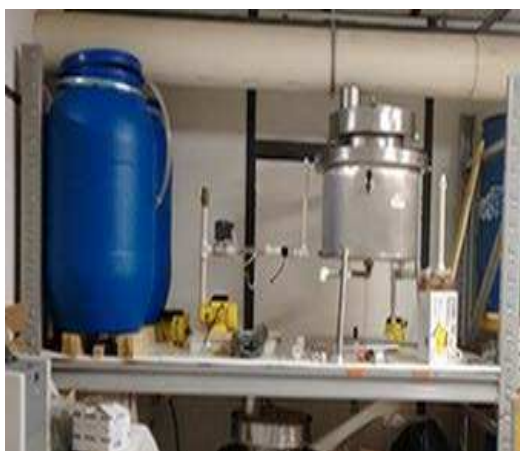
Figura 1 – Planta piloto de cachaça tradicional para o processo de fermentação.
