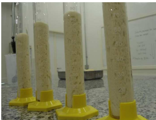
FIGURA 1 - Formação de bolhas de gás na massa Fonte: Autores
