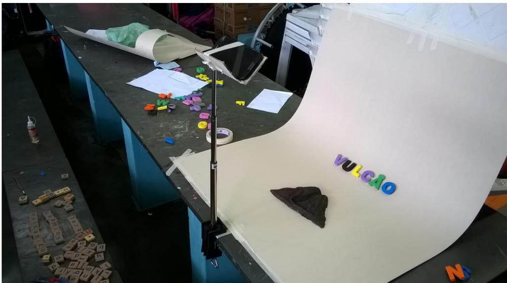
Figura 3: suporte com de parafusadeira adaptado para uso de celular
