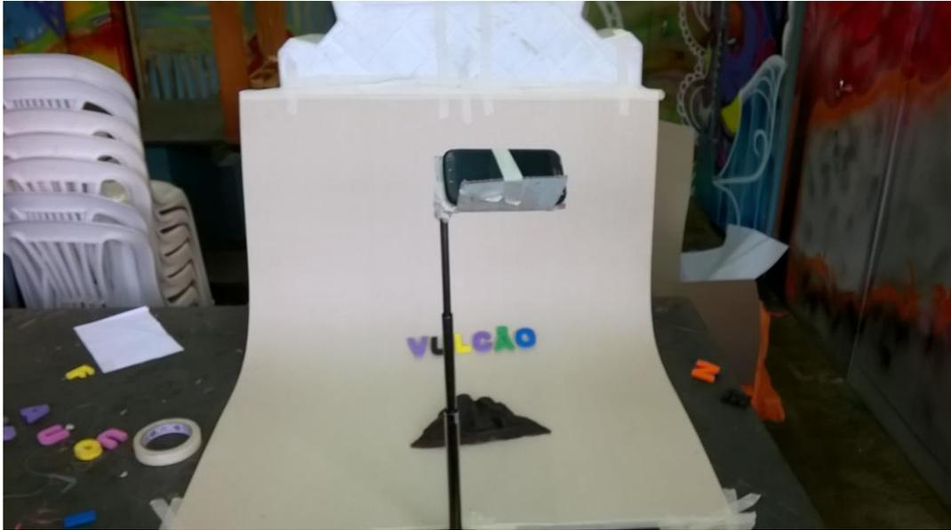
Figura 2: suporte com de parafusadeira adaptado para uso de celular
