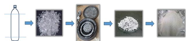
**Figura 1 – Processo de fabricação do pó de PET.**
