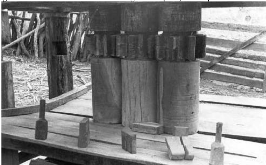
Figura 71 - Detalhe das moendas de “engenheiro de pau”, Município de Minas Novas
