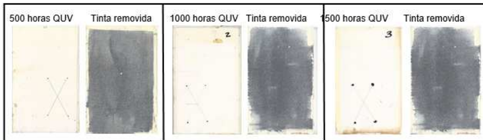
Figura 6 – Aspecto dos painéis depois de 500, 1000 e 1500 horas expostas no teste ciclico de radiação UV (revestida – à esquerda e revestimento removido - direita)
