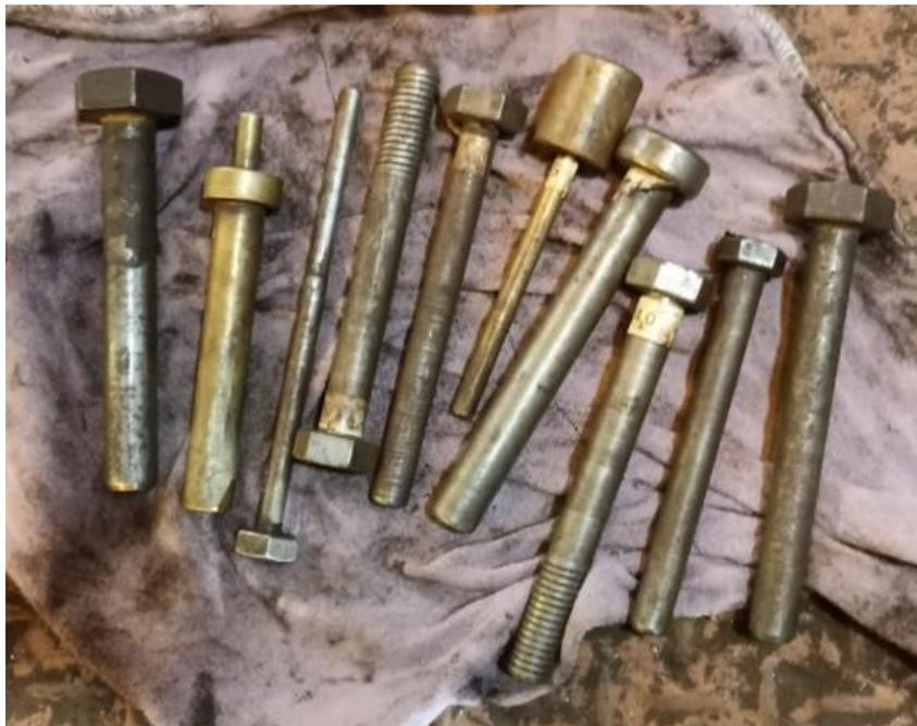
Figura 8. Gabaritos usados para medir os *gaps*.
