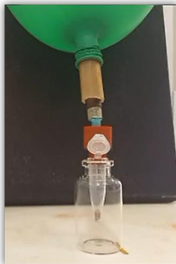
Figura 9. a) Representação das etapas reacionais utilizando balão de nitrogênio para atingir atmosfera inerte. b) Foto representando a troca por atmosfera inerte.
