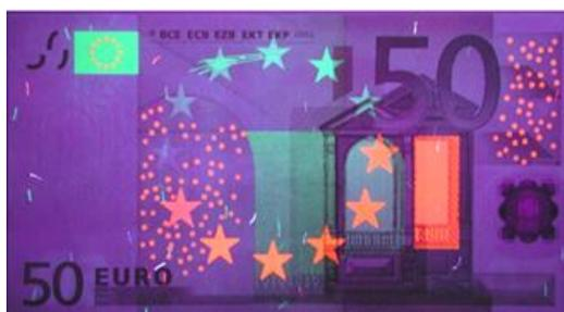
**Figura 21:** Nota de 50 euros irradiada sob luz UV, figuras em vermelho e verde obtidas a partir de compostos de  $\text{Eu}^{3+}$  e  $\text{Tb}^{3+}$ .
