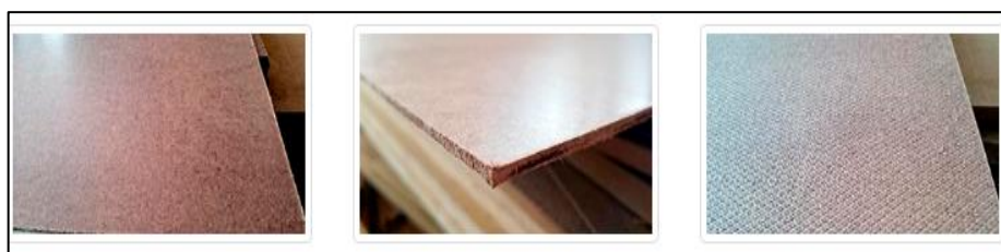
Figura 26 - Chapa dura: uma face lisa e outra corrugada
