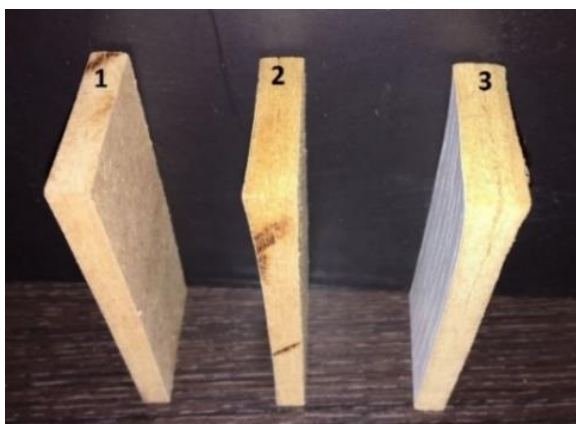
Figura 39 - Amostras de MDF 6mm com deformações
