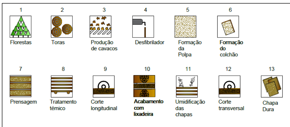
Figura 184 - Esquema Produção Chapa Dura
