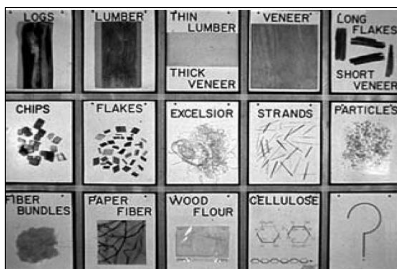
Figura 9 - Geometria da madeira empregados na produção dos painéis de madeira.
