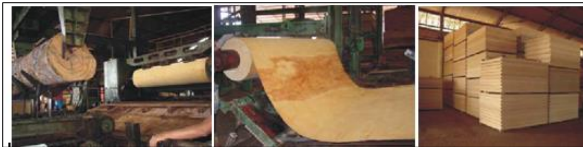
Figura 7 - Processo industrial de laminação para produção de chapas de compensado.
