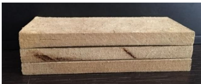
Figura 40 - Deformação das amostras
