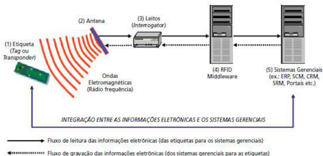
Figura 1 - Funcionamento de sistemas RFID
