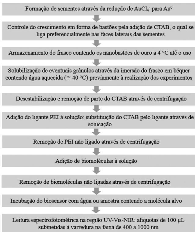
**Figura 4.** Principais etapas de síntese e funcionalização de nanobastões de ouro para desenvolvimento da aula prática utilizando biosensor
